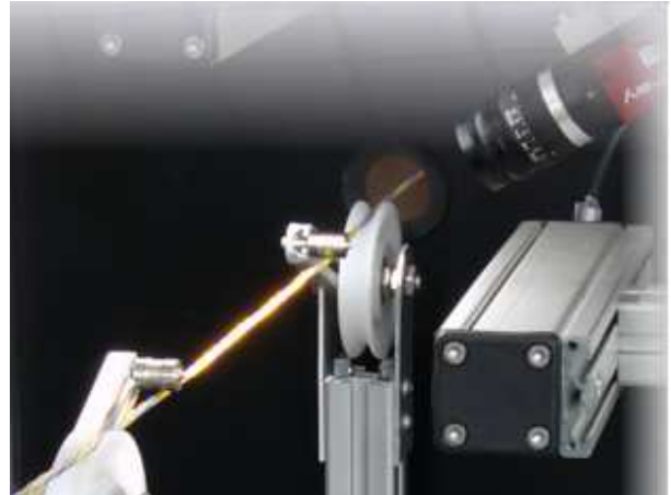
Anwendungsbeispiel: Farbsequenz bei mehradrigen Kabeln
