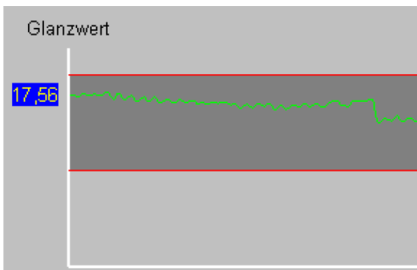
Glanzwertüberwachung innerhalb eines zulässigen Toleranzkorridors
